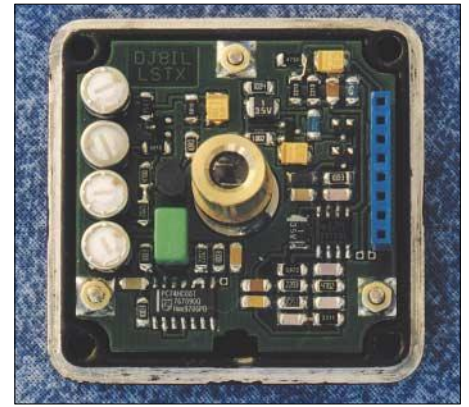
Bild 18: Die optische Achse der im Gehäuse montierten Senderplatine kann man mit den drei Befestigungsschrauben parallel zur Empfängerachse ausrichten. Fotos: DJ8IL
