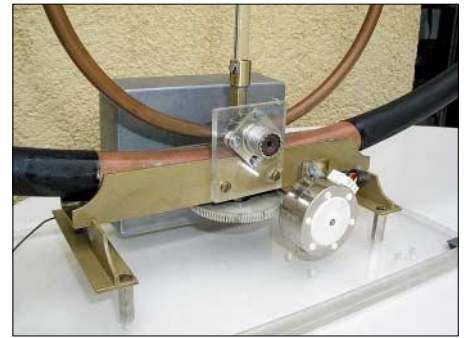
Bild 3: Der an den Drehkondensator einer Magnetantenne gekoppelte Schrittmotor ermöglicht die ferngesteuerte Bedienung.
