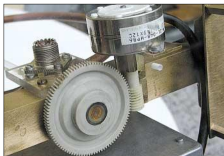
Bild 5: Durch Vorschalten eines Getriebes lassen sich Kraft und Präzision eines Schrittmodorts noch beträchtlich erhöhen.
