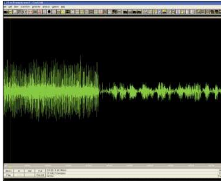
Bild 2: Starke Prasselstörung (man sieht es an den Zacken) im 15-m-Band; zunächst ohne, dann mit Sprachextraktor-Aktivierung; die Störung liegt bei S9, das Sprachsignal weit darunter.
