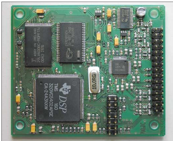
Bild 1: Das Sprachextraktor-Board DX-11. Ins Auge fällt der leistungsfähige DSP-IS von Texas Instruments.
